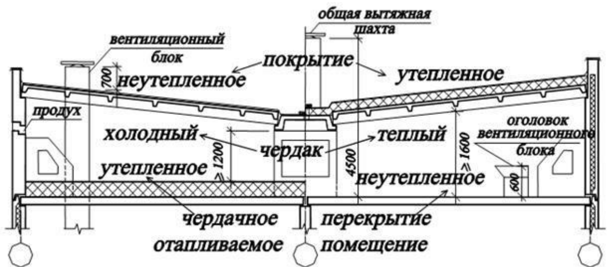
Рисунок 1 - Принципиальная схема чердачной крыши
